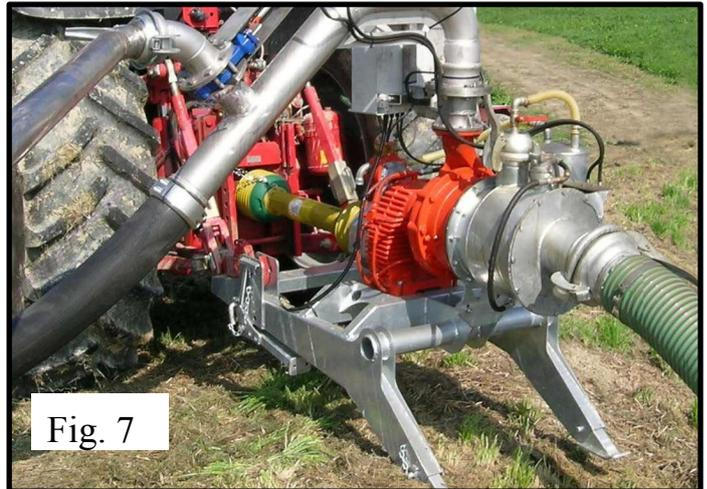
Vérifiez également que la chaîne, fournie pour protéger la transmission par cardan, est connectée à l'anneau prévu à cet effet et que les dispositifs de protection sont intacts.
