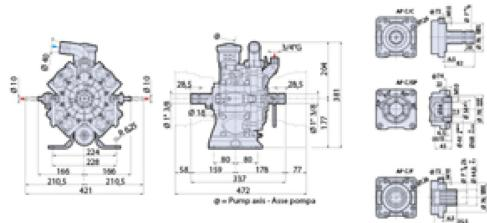
Sur le modèle C/SP, le joint d'étanchéité monté sur le corps de la pompe réduit la valeur A de 17 à 15.
